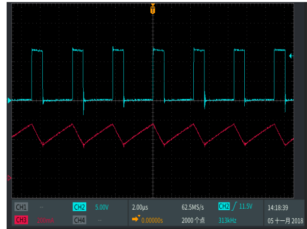
SW 脚与电感电流工作波形
