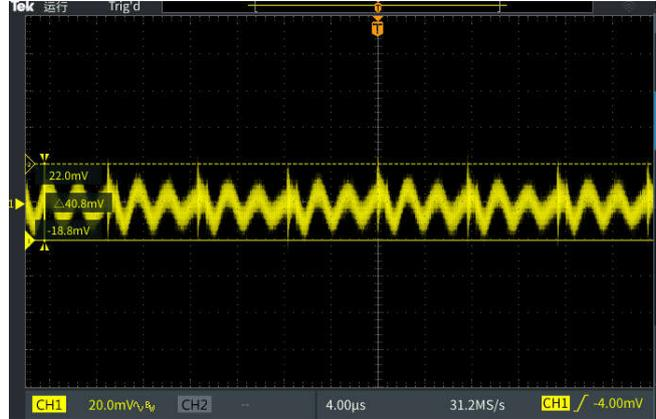
图 5 加 LC 滤波后输出纹波电压  $\Delta V_{pp}=40.8\text{mV}$
